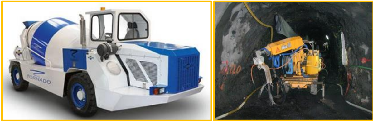
Figura 8-38. Ejemplo Camión de Transporte y Robot de Proyección de Concreto
